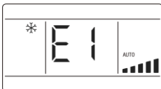
Rys. 6.1 Wyświetlanie aktywacji zabezpieczenia przed wysokim ciśnieniem w jednostce zewnętrznej
